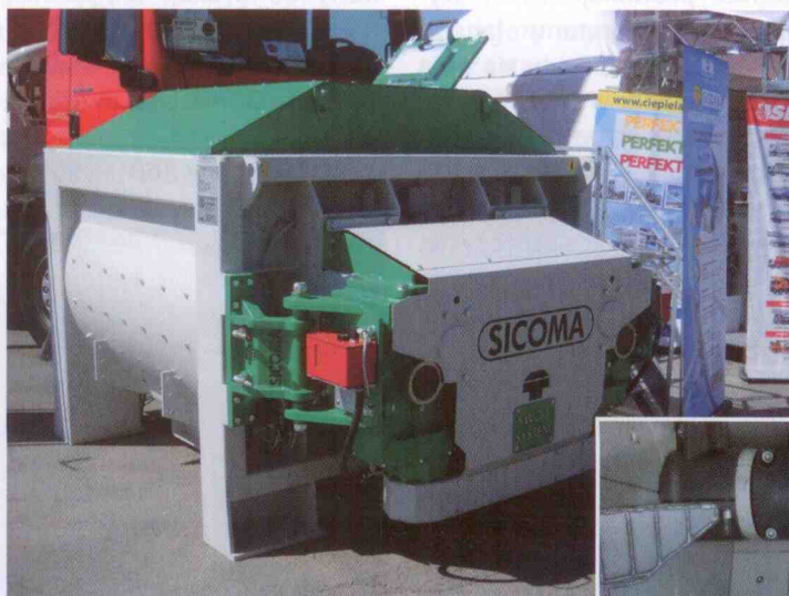
Nowy model mieszalnika do betonu firmy Sicoma ma jeden zespół napędowy dla obu wałów.
