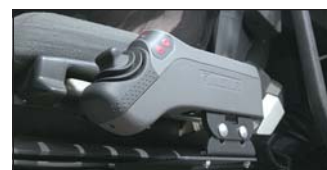
Ergonomiczny panel sterujący umożliwia przewodowe sterowanie hakowcem z zewnątrz
