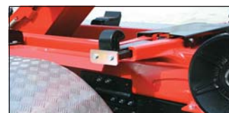
Uniwersalna blokada kontenerów (zewnętrzna lub wewnętrzna)
