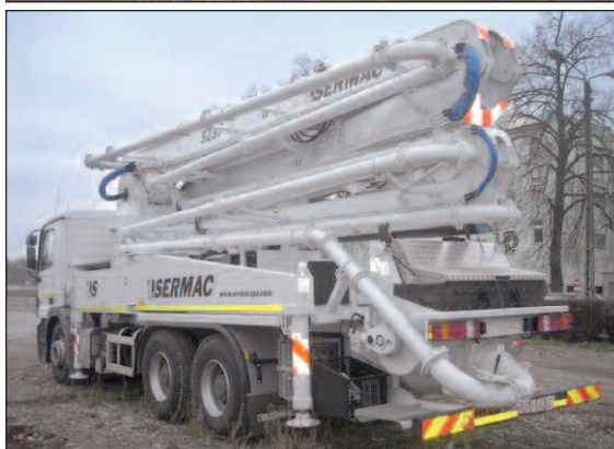
Kompaktowa 5-ramienna pompa 5237 o wysięgu pionowym 37 m na podwoziu 3-osiowym
