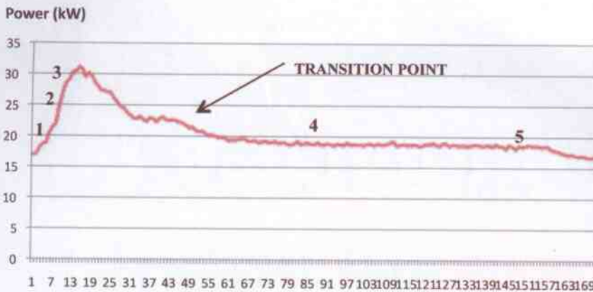
4: Pobór mocy w ramach poszczególnych etapów procedury mieszania. (1 – dozowanie składników, 2 – mieszanie na sucho, 3 – dozowanie wody, 4 – początek opróżniania betoniarki, 5 – koniec opróżniania).
