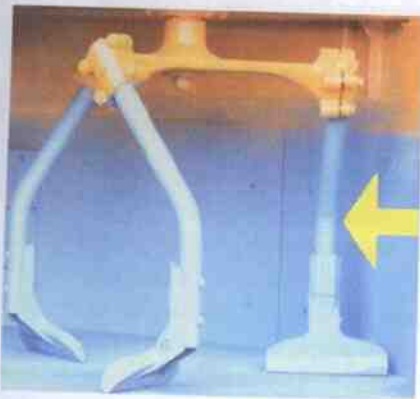
2: Ramiona mieszadła w pierwotnej konfiguracji.
