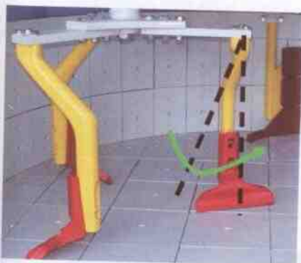
3: Ramiona mieszadła w nowej konfiguracji.
